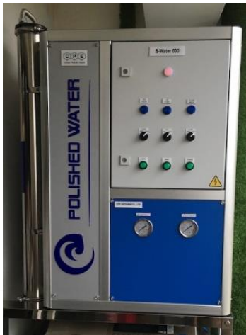
マンション浄水システム
