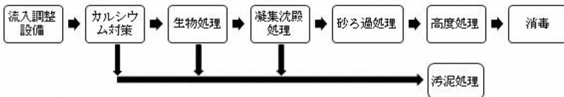
図 12 日本における浸出水処理の基本処理フロー（一例）
