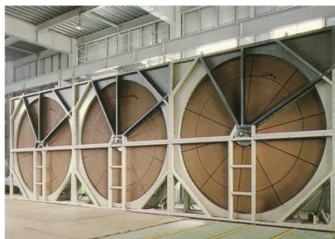
▲ VOC濃縮ローター。無機ハニカムに疎水性ゼオライトが担持されている。
