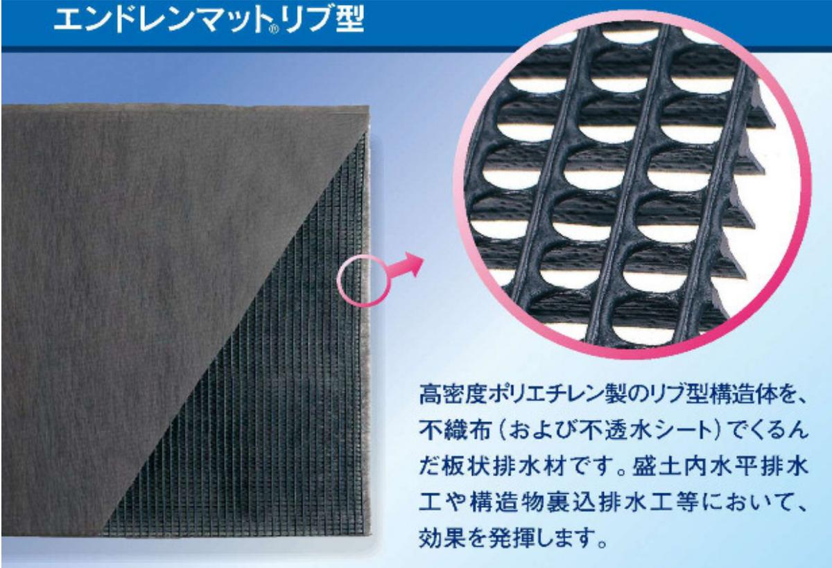
高密度ポリエチレン製のリブ型構造体を、不織布(および不透水シート)でくるんだ板状排水材です。盛土内水平排水工や構造物裏込排水工等において、効果を発揮します。
