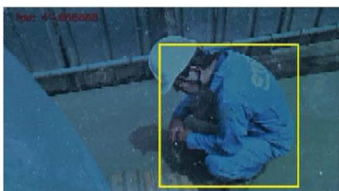
カメラ撮影範囲内に人が侵入するとAIが自動で人を認識、認識と同時に信号<sup>\*</sup>を発信します。
