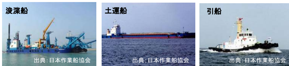
図 6.48 作業船の一例
