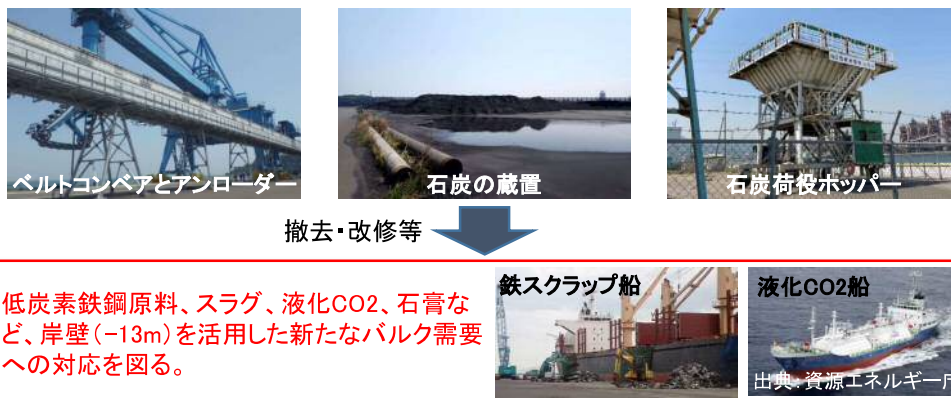
図 6.19 本港 13 号岸壁の再編イメージ
