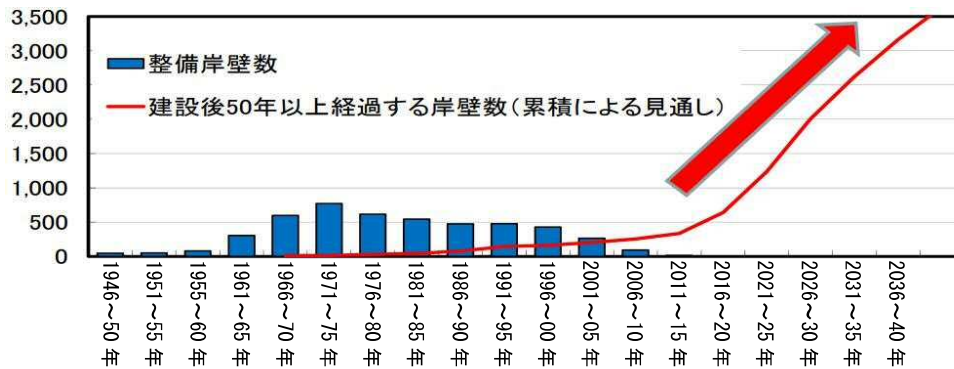
図 4.12 各年度に整備した係留施設数と供用後 50 年以上経過する岸壁数の推移
