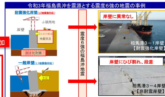
岸壁の地震被災事例(R6能登半島地震)と耐震強化岸壁の整備効果
