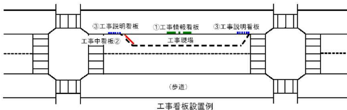
標示板の設置場所
