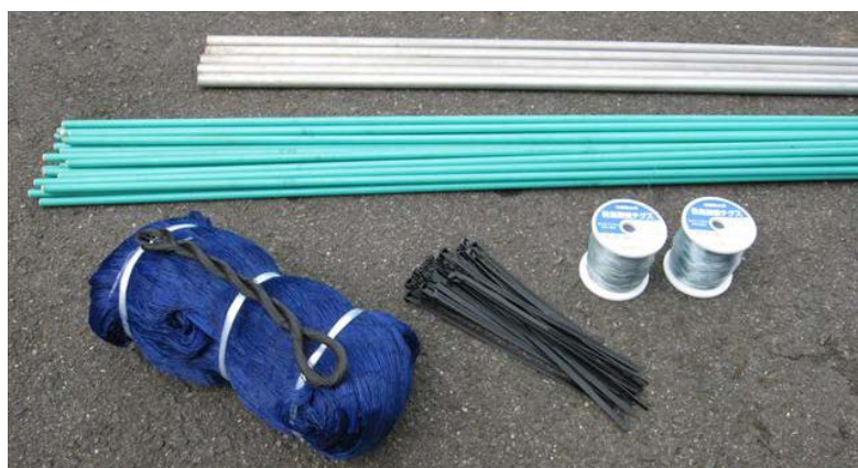
写真1 奥から直管パイプと弾性ポール 手前は左から防鳥網と添付の張り糸、結束バンド、テグス
