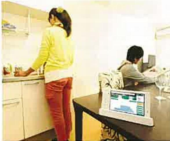
各家庭に設置された「宅内表示器」 需要状況に応じた電気料金や省エネガイドランスを表示
