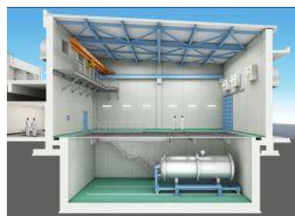
高圧水素ガス試験室
