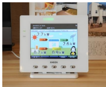
発電状況が一目で分かる エネファームのモニター
