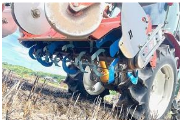
播種部分のみカルチ爪に交換したロータリー
