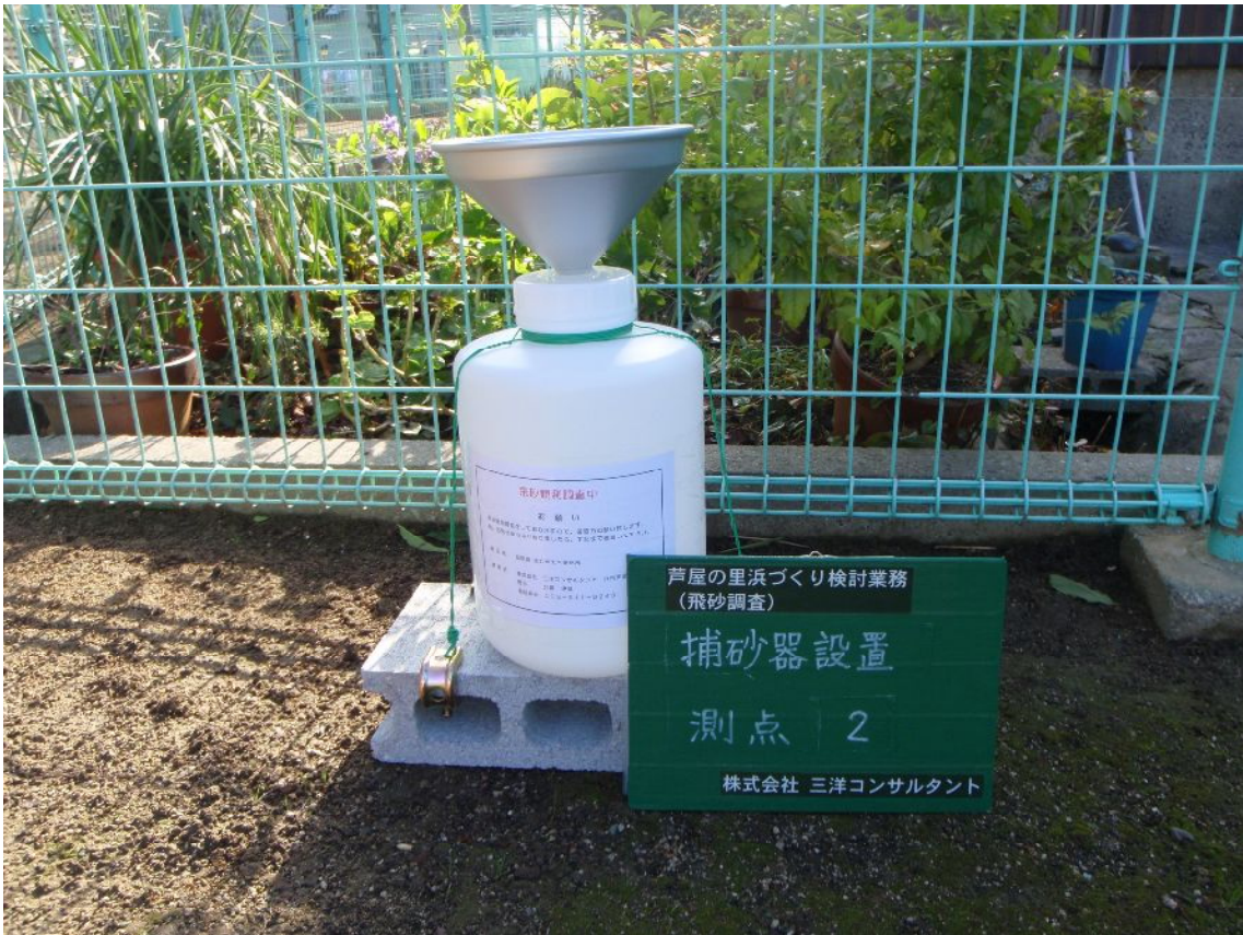
写真1 捕砂器設置状況
