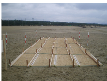
古畳を敷き並べることにより、直接的な飛砂を防止するとともに、植生の基盤材として有効であるか判断するため20畳分設置しました
