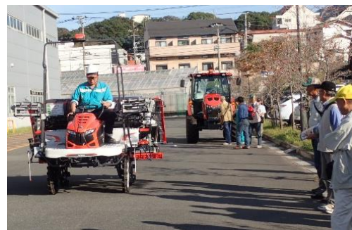
ICTを利用した田植機(左)とトラクター(右)
