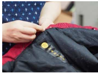
中綿が偏らないよう、 手作業で要所を縫い付 ける
