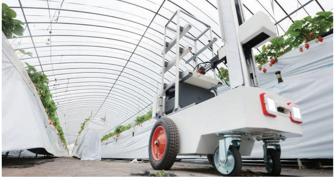
栽培棚の間を自走する自動収穫ロボット
