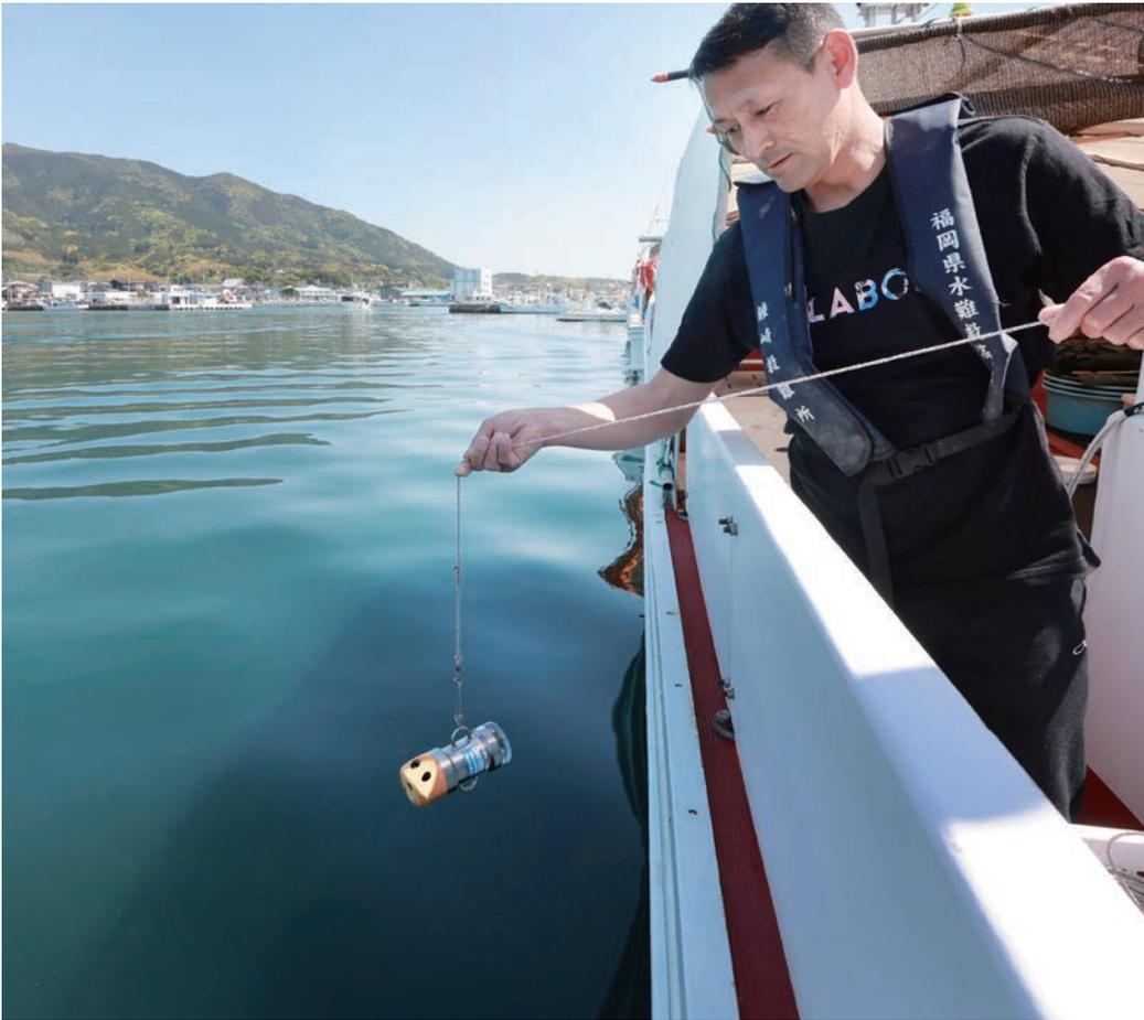
観測機器を海へ投入して水温・塩分などのデータを収集する
