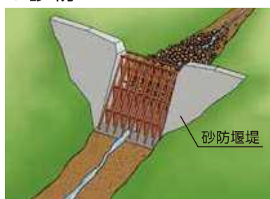
【図】透過型砂防堰堤のイメージ
