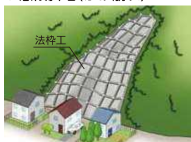
【図】がけ崩れ対策工のイメージ
