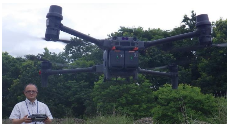
最新型小型赤外線カメラ搭載ドローン
