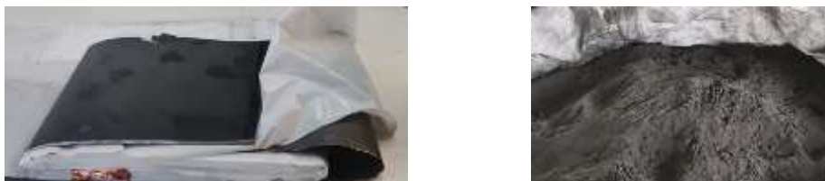
(写真) カバーを取り外した状態の電池 (左) と回収されたブラックマス(電池を乾燥・破碎・選別して回収されるリチウム、コバルト、ニッケルの濃縮粉体) (右)
