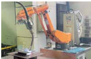
ロボット溶接作業
