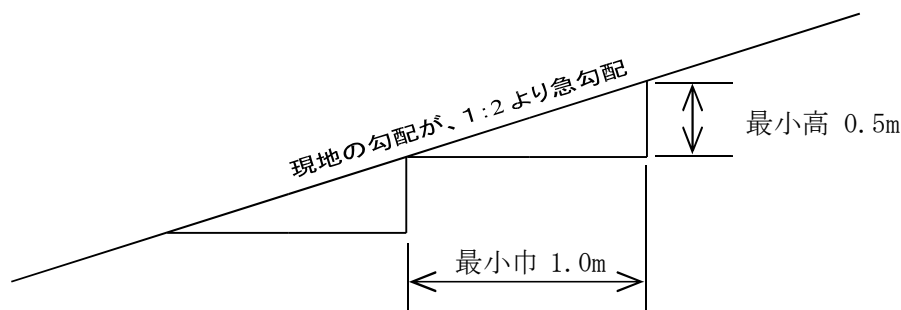
図 1-2-1 盛土基礎地盤の段切
