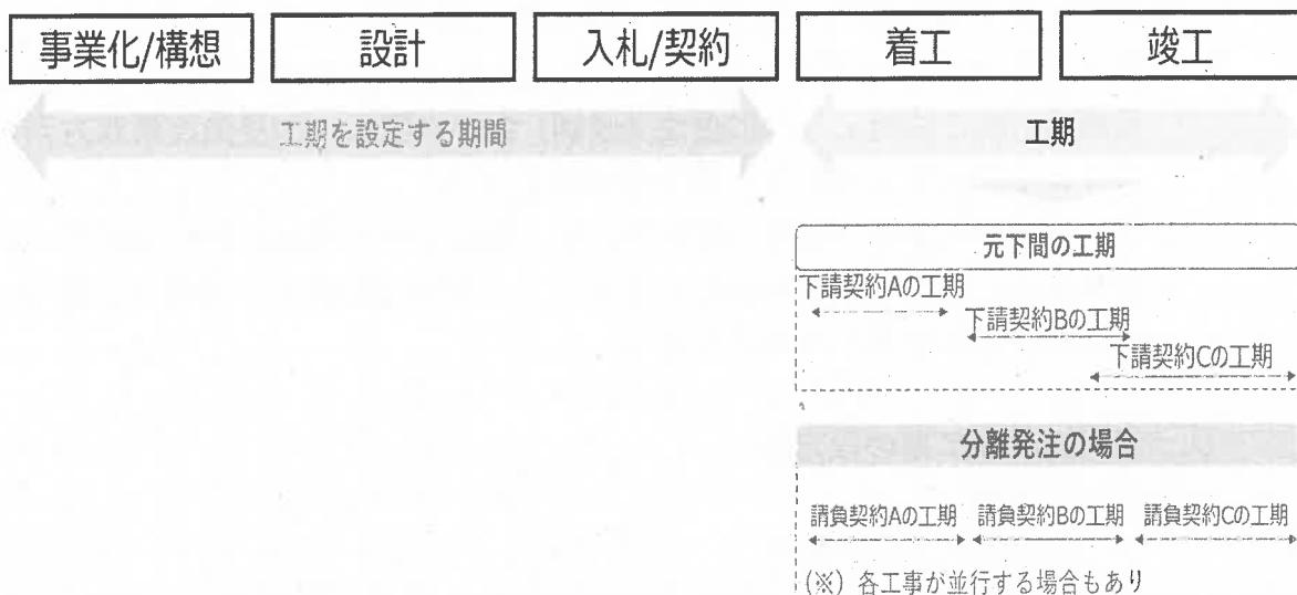
なお、施工段階より前段階の、事業化/構想、設計、資機材の調達等の計画・進捗・品質が工期に影響を与えるため、円滑な進捗や完成度の高い成果物の作成等に努め、工期にしわ寄せが生じないようにしなくてはならない。また、事業化/構想段階、設計段階において工程や工期を検討する場合は、施工段階における適正な工期の確保に配慮することが重要である。
