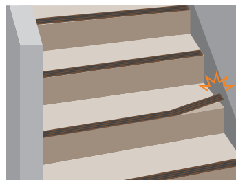
階段の滑り止めの浮き
