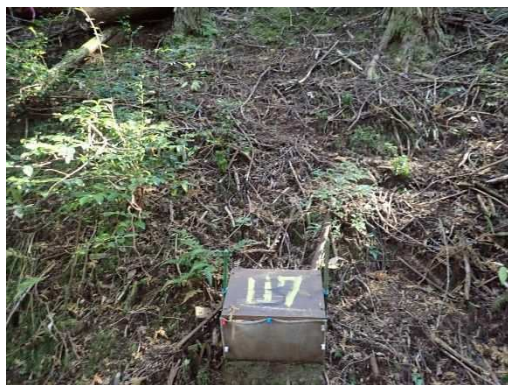
土砂受け箱設置状況
