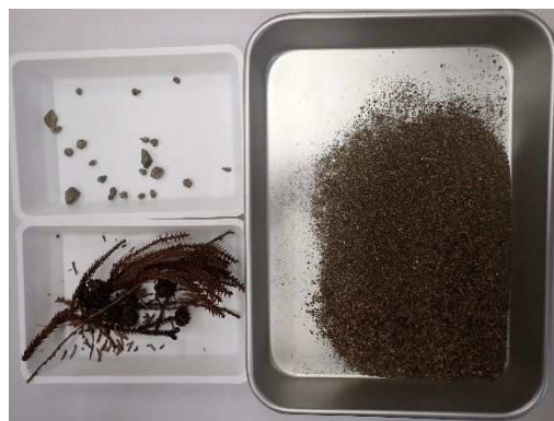
土砂の選別(砂礫、有機物、細土)
