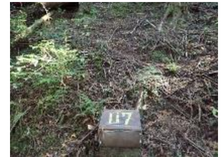
(土砂受け箱設置状況)
