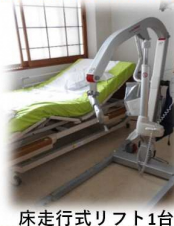
床走行式リフト1台
