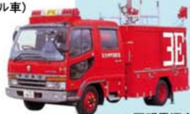
▲照明電源車 Flood Light Wagon
