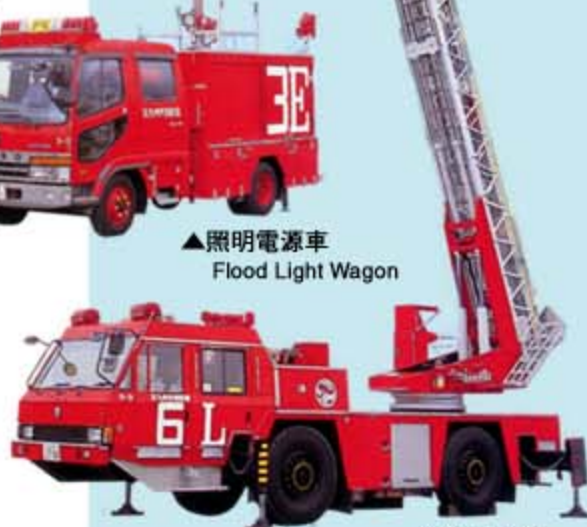
▲はしご車 Aerial Ladder
